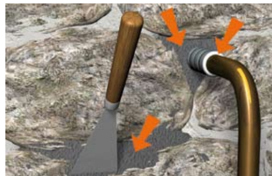
Situation après travaux : colmatage des voies d'eau.
